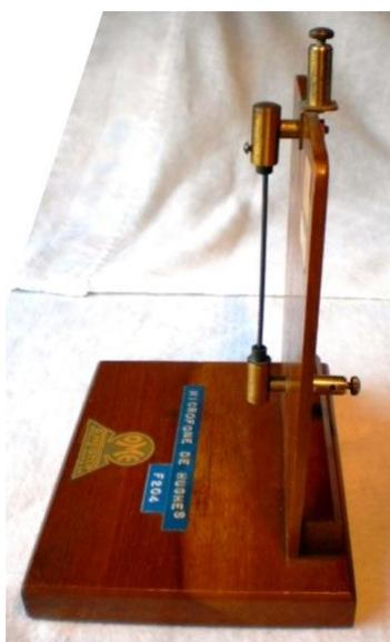
Quanto à escolha dos fones, foi observado que o melhor foi aquele que apresentou uma impedância muito baixa ( $R=20$  ohms) em comparação aos fones usados para receptores de Galena, com alta impedância ( $R>2000$  ohm). A conformidade entre as impedâncias do Microphone e do Fone é vital nestes circuitos não críticos.
